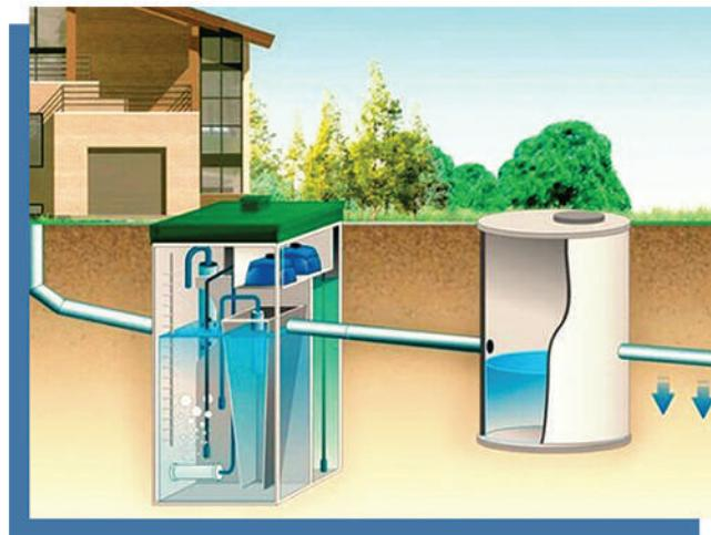
ПРОБЛЕМЫ: НЕПРАВИЛЬНО УЛОЖЕННЫЕ ТРУБЫ, А ИМЕННО ОШИБКИ ПРИ ВЫБОРЕ НАКЛОНА, СТАНУТ ПРИЧИНОЙ ЧАСТЫХ ЗАСОРОВ, ЧТО ВЫЗОВЕТ ПРОБЛЕМЫ В РАБОТЕ ОЧИСТНОЙ СТАНЦИИ И ПОЯВЛЕНИЮ ПЛОХОГО ЗАПАХА В ПОМЕЩЕНИИ. ЕСЛИ НЕОПРАВДАННО ЗАЛОЖИТЬ ТРУБЫ НА БОЛЬШОЙ ГЛУБИНЕ, ТО ЭТО ПРИВЕДЕТ К УВЕЛИЧЕНИЮ КОНЕЧНОЙ ЦЕНЫ ОБОРУДОВАНИЯ И СНИЖЕНИЮ КОЛИЧЕСТВА ЗАЛПОВОГО СБРОСА, НО НЕ ПРИНЕСЕТ ПОЛЬЗЫ ВО ВРЕМЯ ИСПОЛЬЗОВАНИЯ.
